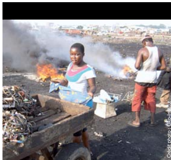
Tri des câbles précédant la récupération du cuivre.
